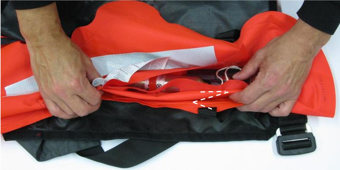
Danach wird dann die untere Kante ebenfalls Z-förmig nach unten gefaltet.
